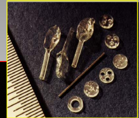
Mikropositionier-system bestehend aus einem aktiven Mikroventilsystem und aufblasbaren Positionierballons. Durchmesser : 2,5 mm..
